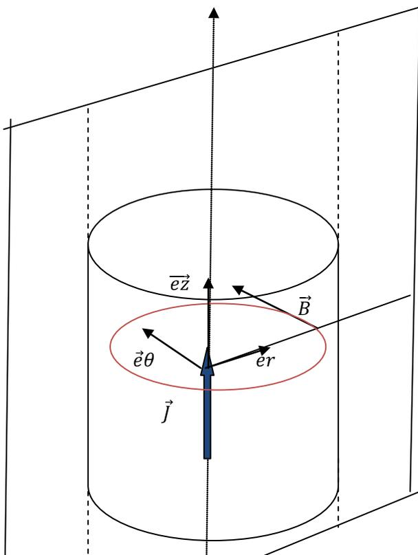
Le plan  $\vec{e}_z \vec{e}_r$  est un plan de symétrie donc  $B$  est perpendiculaire à ce plan. Tous les plans de ce type sont plans de symétrie donc  $B$  est sur un cercle dont le centre appartient à l'axe de rotation. Il y a invariance selon  $z$  et  $\theta$ . En Définitive  $\vec{B} = B(r)\vec{e}_\theta$
